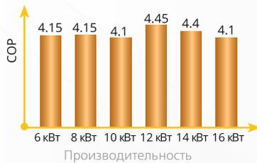
Эффективность системы при работе на обогрев может достигать значений COP=4,5 (для модели производительностью 12кВт)
