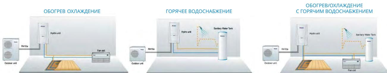
В системе возможно использование фанкойлов различного типа и мощности, применение «теплых полов», накопительного водяного бака. Для дополнительной экономии электроэнергии можно подключить солнечные коллекторы.
