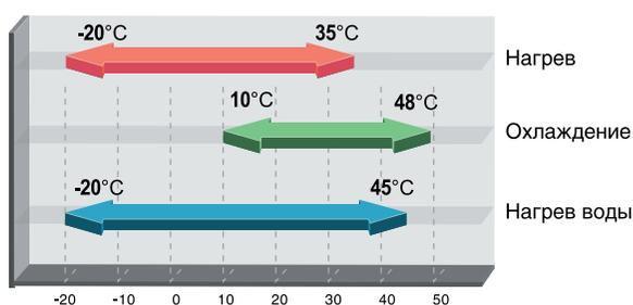
Диапазон температур наружного воздуха для работы системы Versati в различных режимах.
