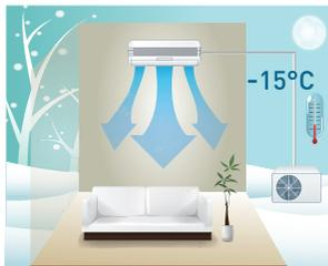
■ **Низкотемпературное охлаждение.** Кондиционер может работать в режиме охлаждения при низких температурах воздуха. В зависимости от температуры на улице изменяется производительность компрессора и скорость вращения вентилятора наружного блока.
