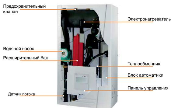
в гидромодуле тепло хладагента передается воде, циркулирующей в контуре центрального отопления, «теплых полах», системе горячего водоснабжения для бытовых нужд.
